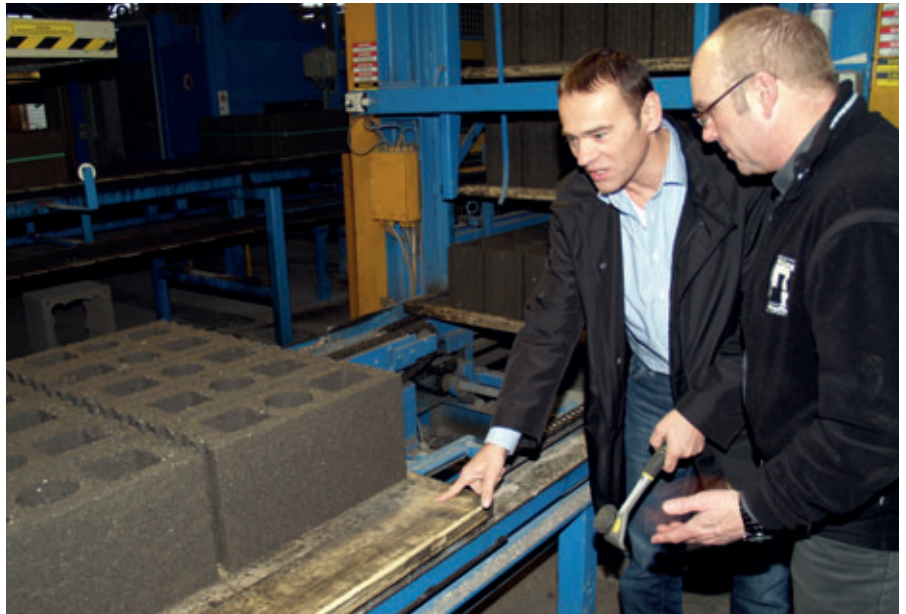
Roland Neumann, Betriebsleiter Rünz & Hoffend KG (re.) und Assyx-Geschäftsführer Alfred Rochlus inspizieren die Unterlagsplatten. Seit 2006 sind 15.000 DuroBoard-Unterlagsplatten in den Produktionsautomaten des Baustoffherstellers im Dauereinsatz und sorgen für reibungslose Abläufe.
