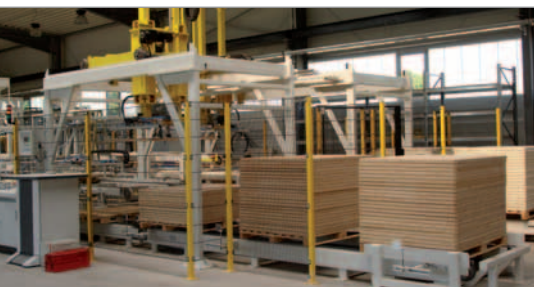
Im Vordergrund befinden sich die am Anfang der Umlaufproduktion gestapelten Laminatkern, im Hintergrund die vollautomatisch gestapelten, fertigen Duroboards.
