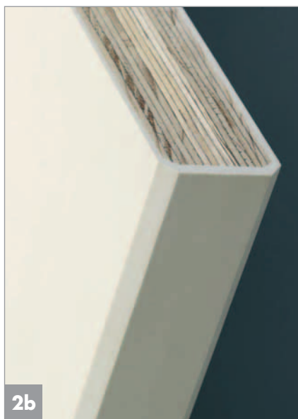
Les couches encollées et croisées sont enrobées de polyuréthane Baydur développé spécialement à cet effet par Assyx en collaboration avec Bayer MaterialScience
