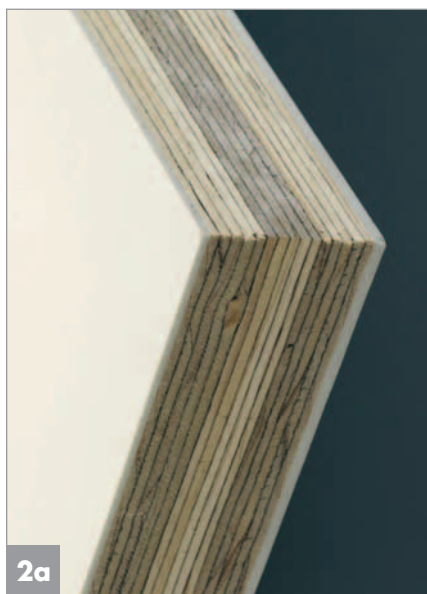
Les couches encollées et croisées sont enrobées de polyuréthane Baydur développé spécialement à cet effet par Assyx en collaboration avec Bayer MaterialScience
