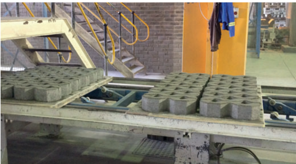
DuroBoards da Assyx em utilização na produção de blocos na Bosun
