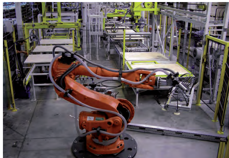
Полностью автоматическое производство Assyx в городе Андернах, Германия
