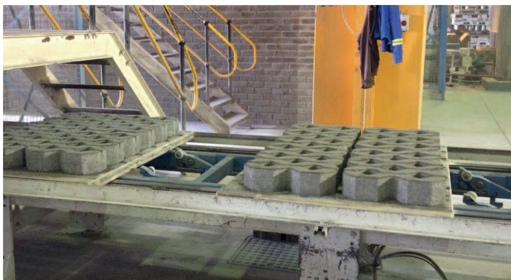
Эксплуатация технологических поддонов Assyx DuroBoards на предприятии по изготовлению бетонных блоков компании Bosun
