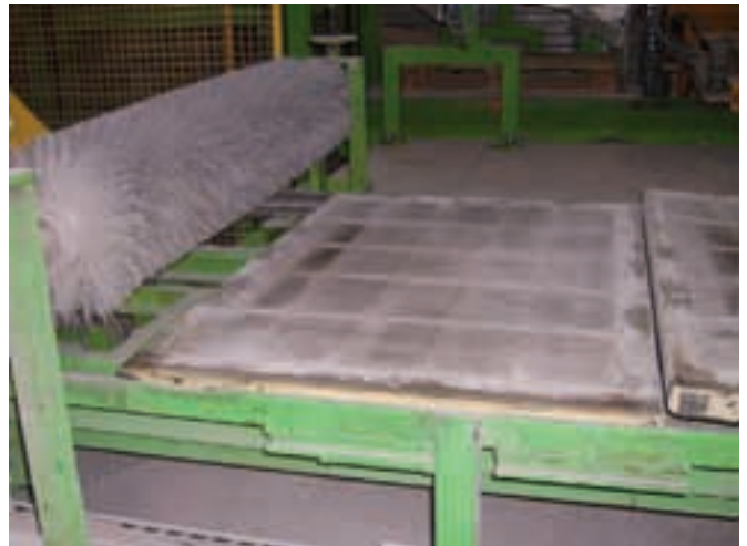
Компания EHL AG оснастила в 2007 году четыре своих завода опорными плитами ASSYX DuroBoard.
