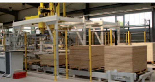
En primer plano se encuentran los núcleos laminados apilados al inicio del circuito de producción, en segundo plano los Duroboards terminados y apilados de forma totalmente automática.
