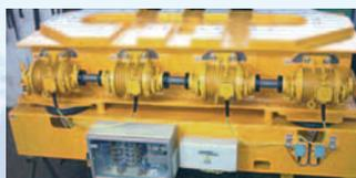
△ Mesas vibratorias: – para compactar elementos de hormigón, desde cubos de prueba hasta, por ejemplo, tubos de grandes dimensiones. Como sistema independiente o formando parte de un concepto global.
